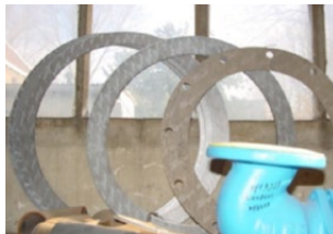
losse pakkingen in opslag. Veelal in magazijn Technische Dienst
